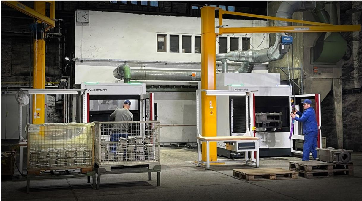
**Hohe Zeitersparnis, Personalentlastung und eine verbesserte reproduzierbare Bearbeitungsqualität: Von all diesen Vorteilen profitiert die Schmiedeberger Gießerei bereits mit der ersten automatischen Gussputzmaschine der Firma Reichmann - und möchte mehr davon. Die Kombination der Maus 600 mit der neuen Maus 900 erweitert die automatische Gussnachbearbeitung für das breite Gussteilspektrum der Gießerei.**
